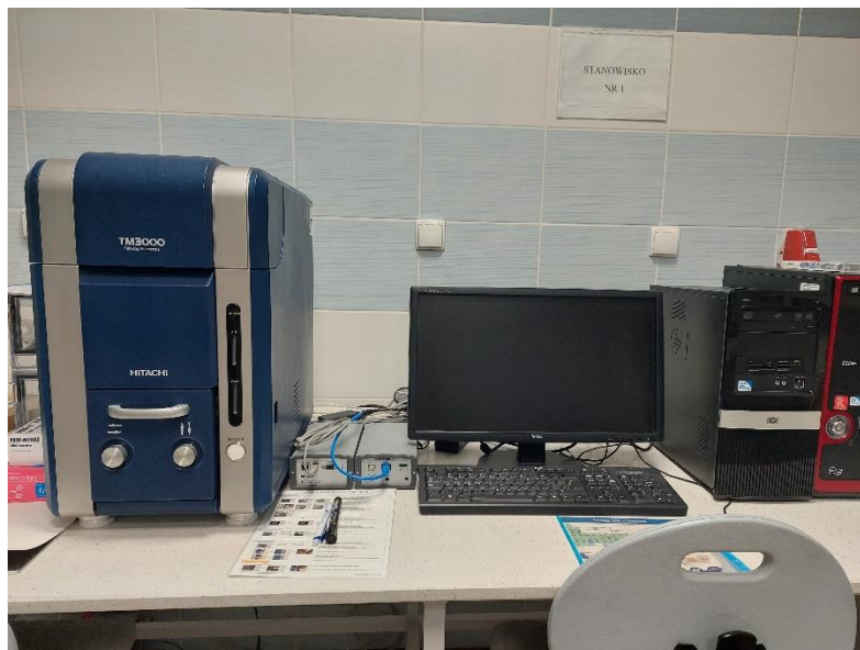
Rysunek 59. Stanowisko ze skaningowym mikroskopem elektronowym (SEM) Hitachi TM3000.
