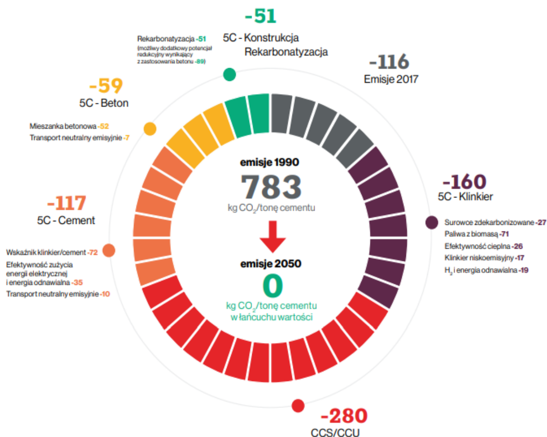
Rysunek 37. Mapa drogowa CEMBUREAU do roku 2050 Całkowita eliminacja CO 2 w łańcuchu wartości cementu (5 punktów: klinkier, cement, beton, budownictwo, rekarbonatyzacja) [266].
