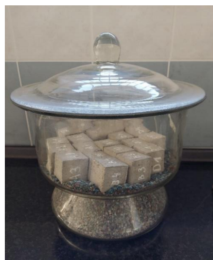
Rysunek 54. Eksykator szklany z żelem krzemionkowym do przechowywania suchych próbek.
