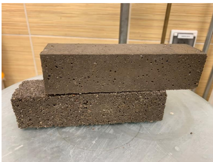
Rysunek 48. Próbki zaprawy z gliną kopalnianą w ilości 5 % masy cementu z różnym wskaźnikiem wodno-cementowym.
