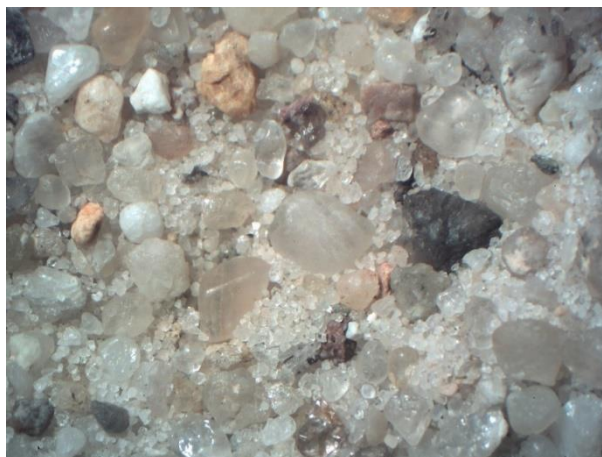
Rysunek 40. Piasek normowy w powiększeniu 10x.
