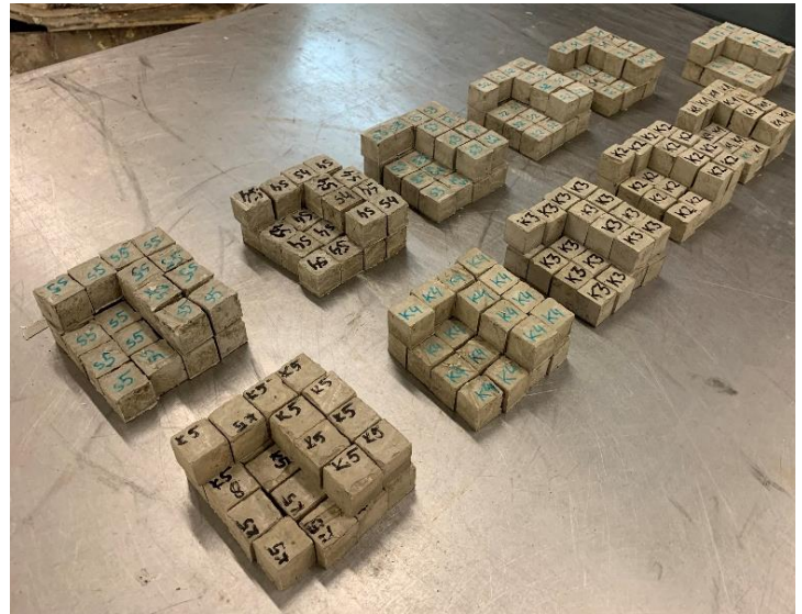
Rysunek 51. Rozformowano próbki zaczynów cementowych.
