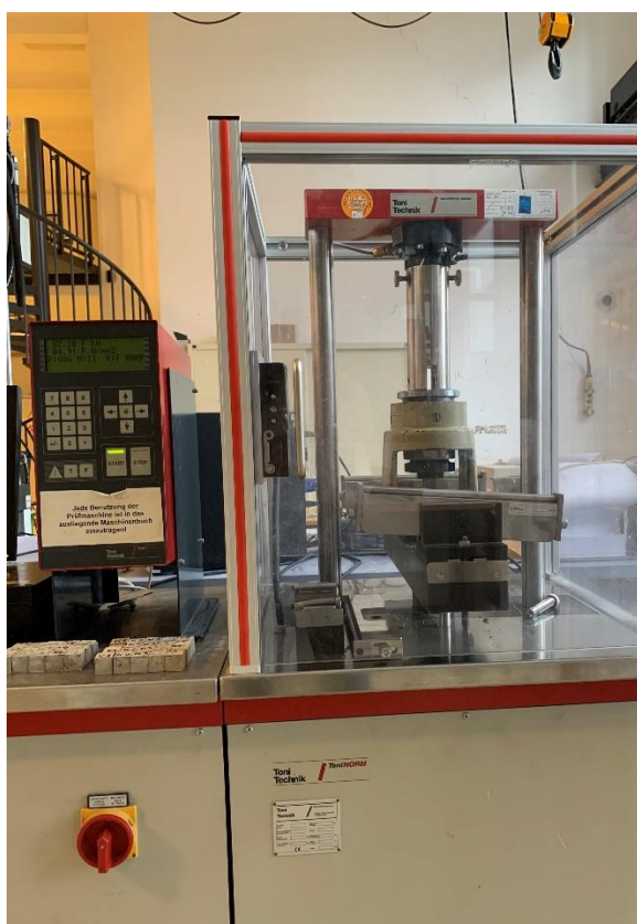
Rysunek 60. Prasa hydrauliczna Toni Technik (a) i (b).
