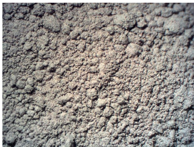
Rysunek 43. Glinka haloizytowa z kopalni Dunino, powiększenie 15x.
