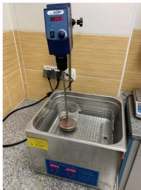
Rysunek 46. Mieszadło mechaniczne ChemLand oraz myjka ultradźwiękowa VEVOR.
