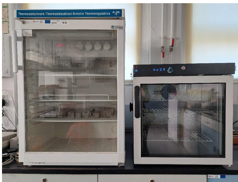
Rysunek 49. Komory termostatyczne do przechowywania próbek w temperaturze 5 °C oraz 10 °C.
