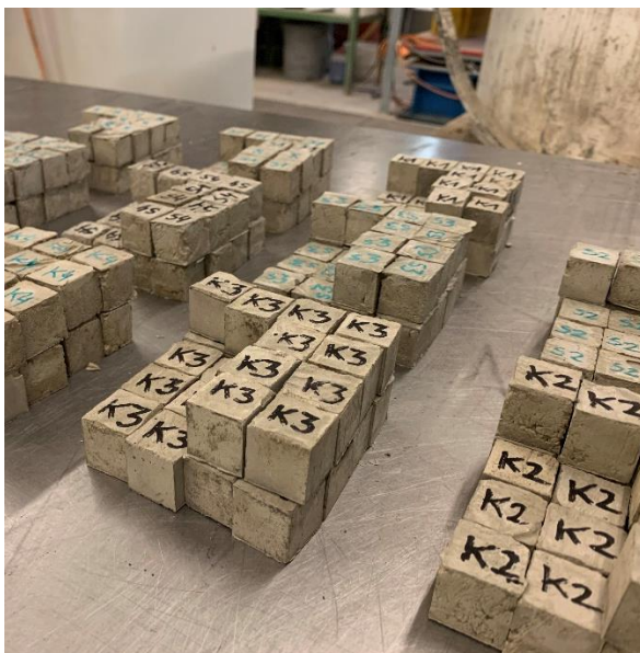
Rysunek 55. Próbkę zaczynów po rozformowaniu.
