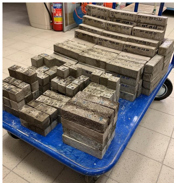
Rysunek 56. Próbkę zapraw po rozformowaniu.
