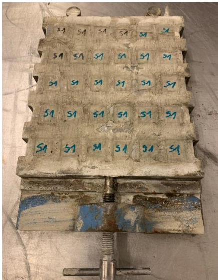
Rysunek 50. Forma do wykonania próbek 20 x 20 x 20 mm.
