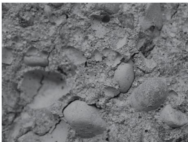
Rysunek 24. Przełom próbki betonu po działaniu temperatury 600°C [176].
