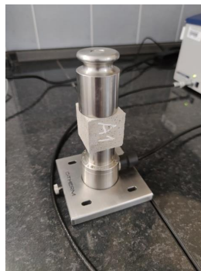
Rysunek 65. Sensor C-Therm TCi do badania przewodności cieplnej.
