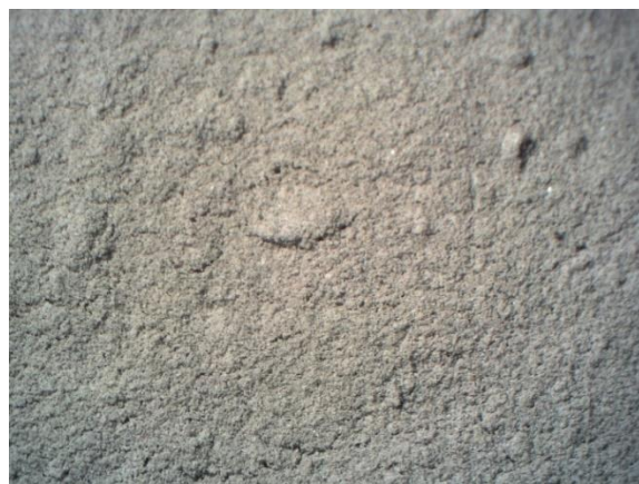
Rysunek 39. Cement 42,5 R w powiększeniu 10x.
