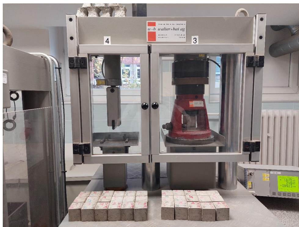
Rysunek 61. Prasa hydrauliczna Walter+Bai ag.
