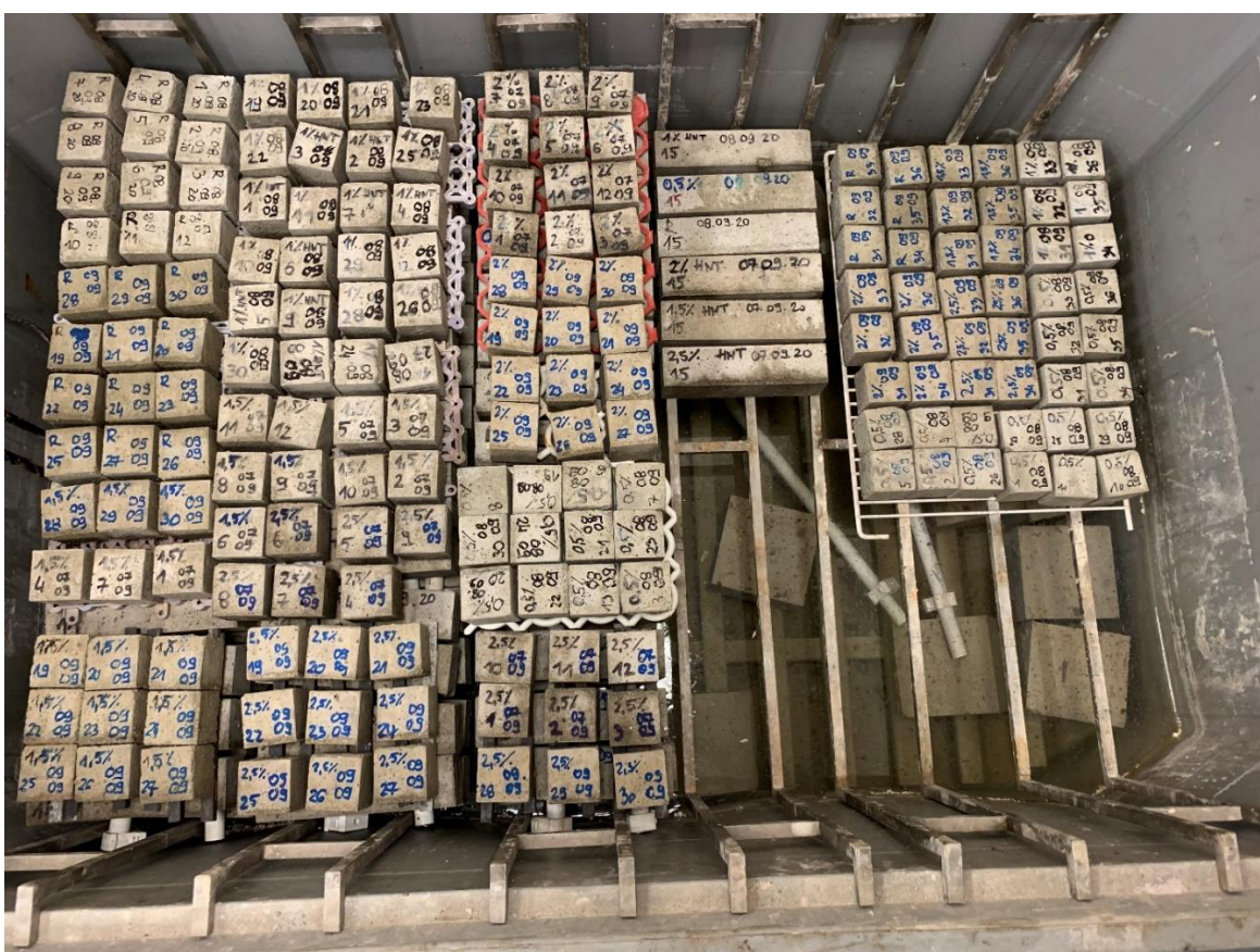
Rysunek 57. Próbkę przeznaczony do badań podczas sezonowania w wannie nad wodą.
