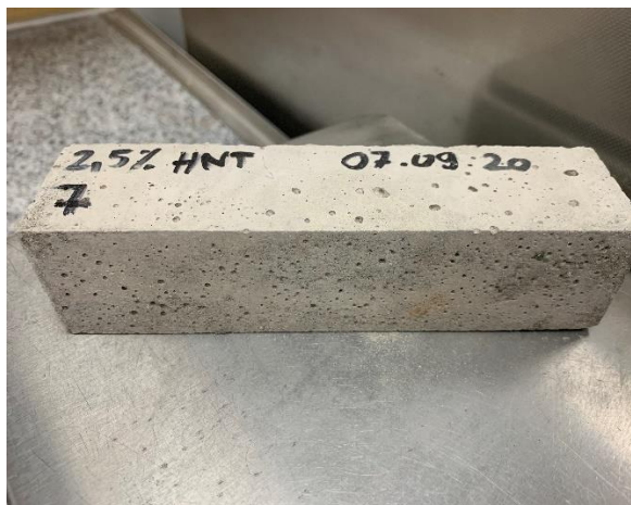
Rysunek 100. Zaprawa 2,5 HNT nie poddana procesowi wygrzewania.
