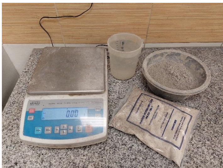
Rysunek 41. Stanowisko do odmierzania próbek z wagą oraz materiałami: wodą wodociągową, piaskiem normowym oraz cementem 42.5 R.
