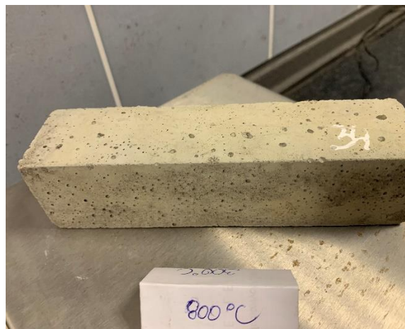
Rysunek 101. Zaprawa 2,5 HNT poddana procesowi wygrzewania w temperaturze 800 °C.
