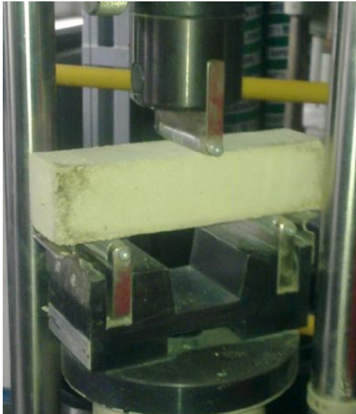
Rys. 5.1 Badanie wytrzymałości na zginanie (a) oraz ciskanie (b) zaprawy zgodnie z norm [127]
