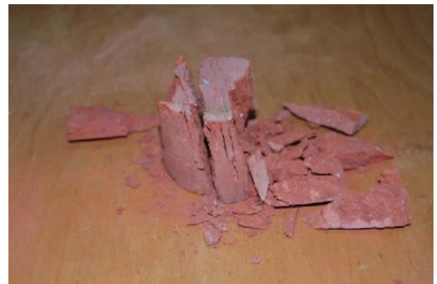
Rys. 4.23 Podstawowe mechanizmy zniszczenia próbek rdzeniowych przy ciskaniu
