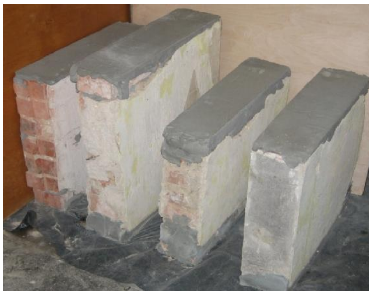
Rys. 2.5 Wycinanie fragmentów muru ze ściany (a) oraz ich przygotowanie do badań wytrzymałościowych na ściskanie (b)
