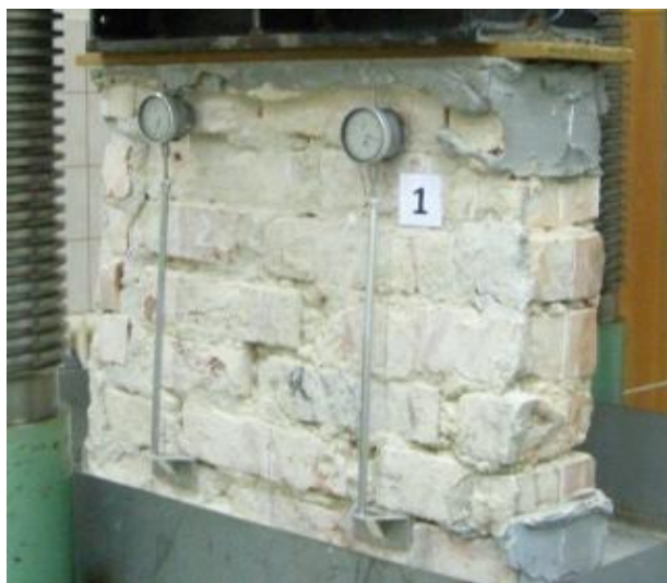
Rys. 6.21 Badanie wytrzymałości na ściskanie fragmentu muru próbki pobranej z wyburzanej kamienicy
