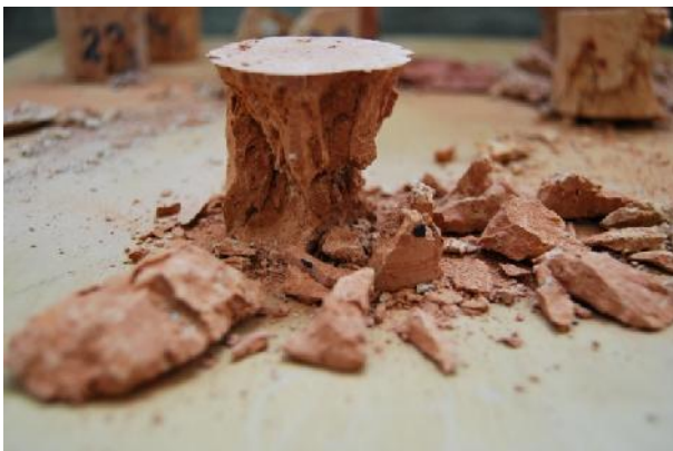
Rys. 4.23 Podstawowe mechanizmy zniszczenia próbek rdzeniowych przy ciskaniu
