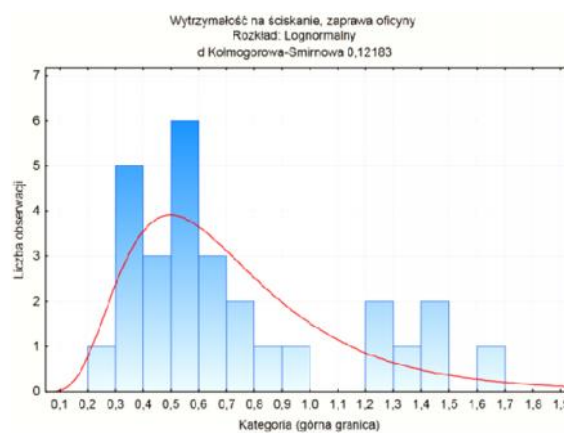
Rys. 5.12 Histogramy i rozkłady statystyczne wyników badań wytrzymałości na ciskanie zaprawy według schematu 1 Tablicy 5.3 z nowo wykonanego muru (a) oraz wyburzonej kamienicy (b)
