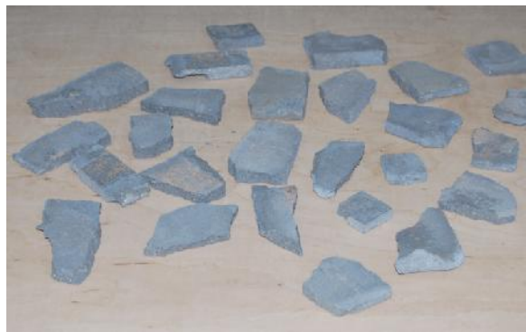
Rys. 5.10 Próbki zaprawy pobrane do badań wytrzymałości na ściskanie według [116]: a) z wyburzanej kamienicy, b) z nowo wykonanego muru
