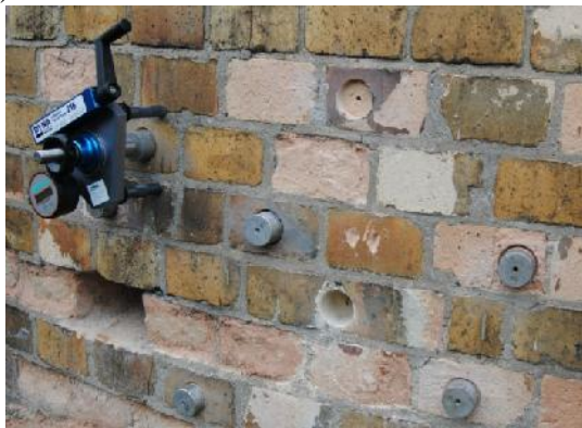
Rys. 6.2 Badanie wytrzymałości cegły na odrywanie in situ metodą pull - off na kominie zlokalizowanym na terenie Zakładu Gazowniczego w Szczecinie
