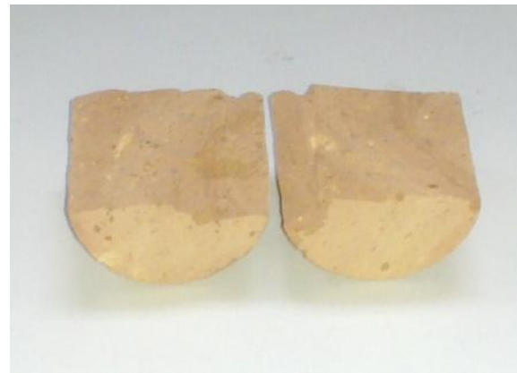
Rys. 6.8 Mechanizm niszczenia próbek podczas badania wytrzymałości na rozciąganie przy rozłupywaniu
