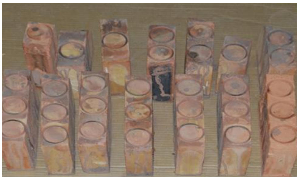
Rys. 4.21 Elementy murowe podczas pobierania rdzeni do badań wytrzymałościowych
