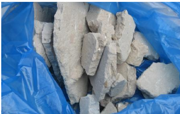
Rys. 5.10 Próbki zaprawy pobrane do badań wytrzymałości na ściskanie według [116]: a) z wyburzanej kamienicy, b) z nowo wykonanego muru
