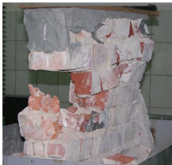
Rys. 6.21 Badanie wytrzymałości na ściskanie fragmentu muru próbki pobranej z wyburzanej kamienicy
