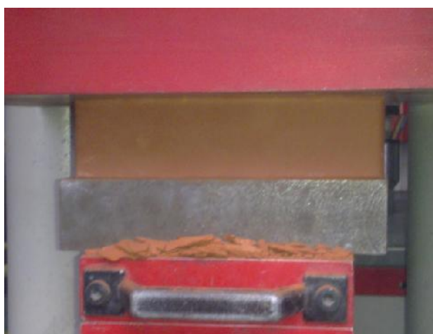
Rys. 4.7 Badanie wytrzymała ci cegły na ciskanie (a) i na rozciąganie poprzez zginanie (b)
