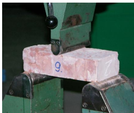
Rys. 4.7 Badanie wytrzymała ci cegły na ciskanie (a) i na rozciąganie poprzez zginanie (b)
